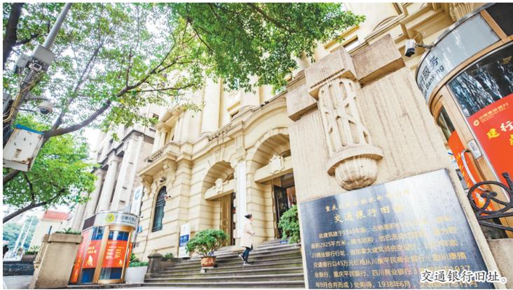
交通银行旧址。该旧址位于打铜街14号，是加拿大建筑师倍克设计，由汉口迁渝的洪发利营造厂在1935年年底建成。坐北朝南，仿巴洛克式风格，为钢筋砼与砖石木混合结构，建筑面积2925平方米，原是川康平民商业银行。
